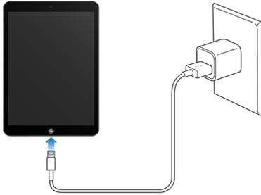
iPad potrebbe inoltre ricaricarsi lentamente se collegato a un porta USB 2.0 sul computer. Se il Mac o il PC non forniscono abbastanza corrente per caricare iPad, nella barra di stato viene visualizzato il messaggio “Non in carica”.
