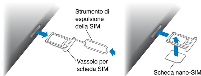
**Aprire il vassoio della scheda SIM:** inserisci lo strumento di espulsione della SIM nel foro del vassoio della scheda SIM, quindi premi con decisione e spingi dentro lo strumento fino a quando il vassoio viene espulso. Estrai il vassoio della scheda SIM per installare o sostituire la scheda SIM. Se non disponi dello strumento di espulsione della SIM, prova a utilizzare la punta di una graffetta piccola.
