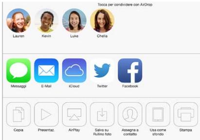
AirDrop ti permette di condividere foto, video, siti web, posizioni e altri elementi con altri dispositivi iOS 7 intorno a te che supportino AirDrop utilizzando la rete wireless. AirDrop richiede un account iCloud e trasferisce le informazioni utilizzando la rete Wi-Fi o quella Bluetooth. Devi essere collegato alla stessa rete Wi-Fi o a circa 30 piedi (10 metri) dall'altro dispositivo. Ai fini di sicurezza, i trasferimenti vengono codificati.
